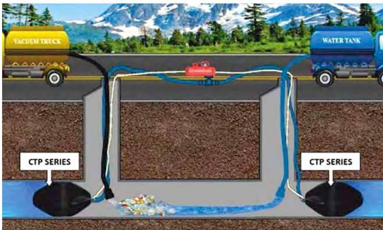
Image-6 Série CTP pour dérivation d'eau de canalisation pour nettoyage
